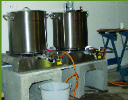
Hier wird die Maische im Läuterbottich in feste und flüssige Bestandteile getrennt.
